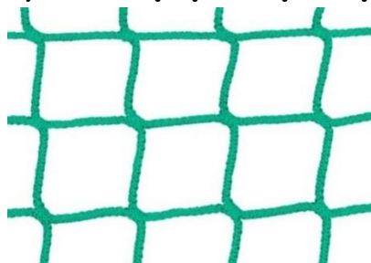
Fot. 5. Standardowa siatka ochronna bezwęzłowa, z polipropylenu o wysokiej wytrzymałości, średnica linki 5 mm, rozmiar oczka 8,0 x 8,0 cm.
